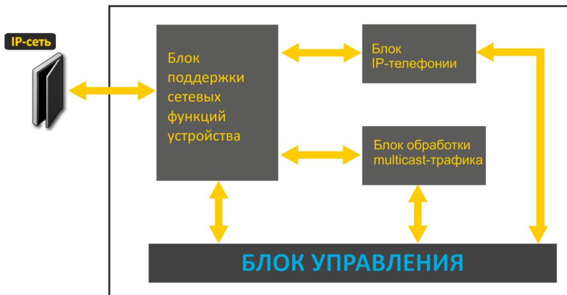
Рисунок 3 — Функциональная схема устройства серии TAU-4M.IP
